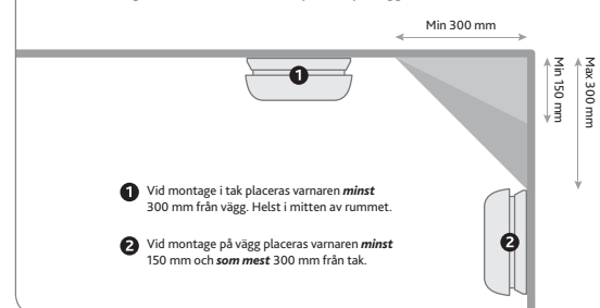
Bild 3. Placering av brandvarnare i tak respektive på vägg.
